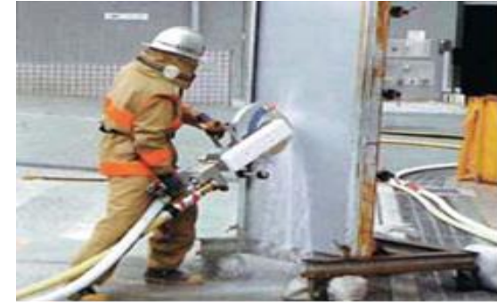
【消防防災科学技術研究推進制度の研究 成果(高圧水駆動カッター)】
