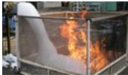
【泡消火実験の様子】
